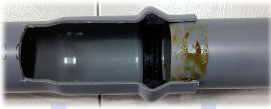
Img. 3 : Bout male du tube + partie intérieure du joint lubrifié
