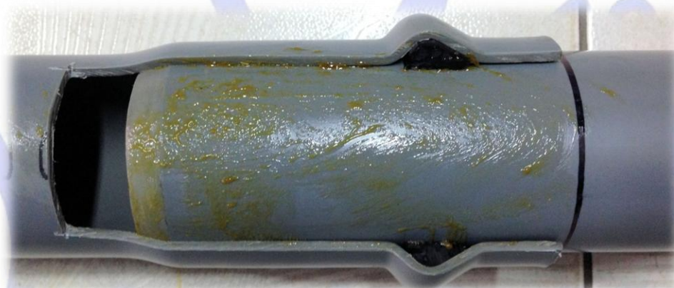
Img. 4 : Tubes emboîtés jusqu'au repère
