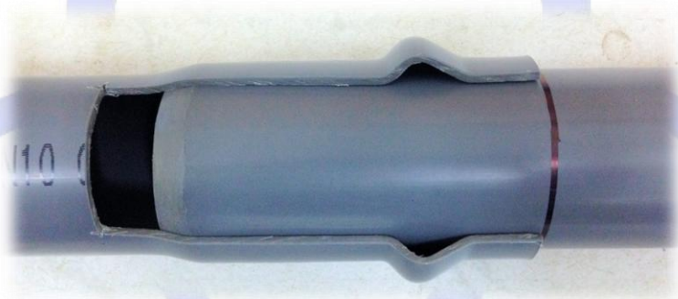
Img. 1 : Repère de la longueur de l'emboîture
